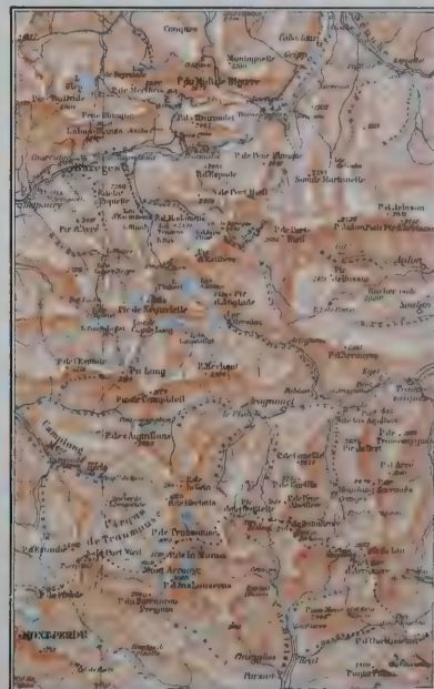
Vollständig ausgeführte Schummerung
